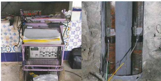
Fig. 13. Instrumentación de los tirantes mediante galgas extensométricas para el control de su estado tensional durante el proceso de puesta en carga. | Instrumentació dels tirants mitjançant galgues extensomètriques per al control del seu estat tensional durant el procés de posta en càrrega.
