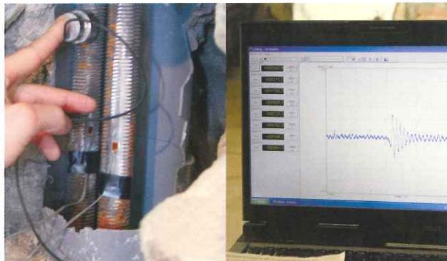
Fig. 14. Instrumentación de los tirantes mediante análisis como cuerda vibrante. | Instrumentació dels tirants mitjançant anàlisis com a corda vibrant.
