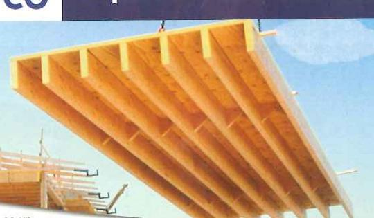
El Panel Autoportante es un producto desarrollado por **Finnforest** basado en la madera microlaminada KERTO. Este tipo de panel de grandes dimensiones, está formado por vigas de Kerto-S a las que se les ha encolado por una o dos caras un panel de Kerto-Q. Es un sistema de gran inercia, que permite cubrir grandes luces con cantos reducidos, así como soportar cargas elevadas.
